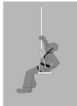
Sistema de ascenso/descenso controlado
